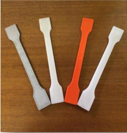
I provini utilizzati in questo studio sono conformi alla norma ASTM D638. Sono stati realizzati con riempimento al 15%, 80% e 100% ed orientamento di costruzione parallelo al piano XY e al piano XZ.
