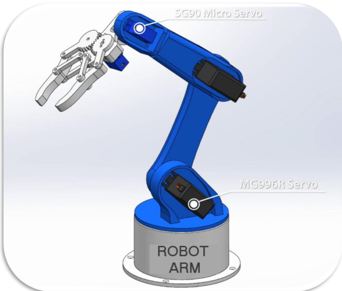
Il progetto prevede il disegno, la stampa 3D, l'assemblaggio e la programmazione di base di un braccio antropomorfo a 5 gradi di libertà, dotato di pinza terminale.
