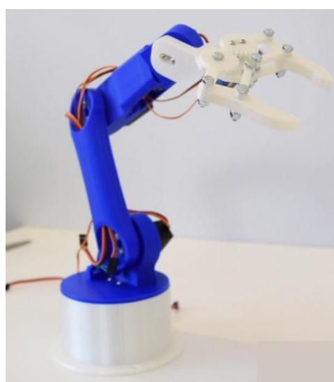
All'asse della spalla è una buona idea includere qualche tipo di molla (o un elastico) per dare un po' di aiuto al servo perché questo servo porta anche tutto il peso del resto del braccio e il carico utile.
